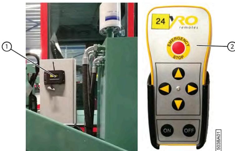
Fig. 31: Télécommande avec émetteur/récepteur
