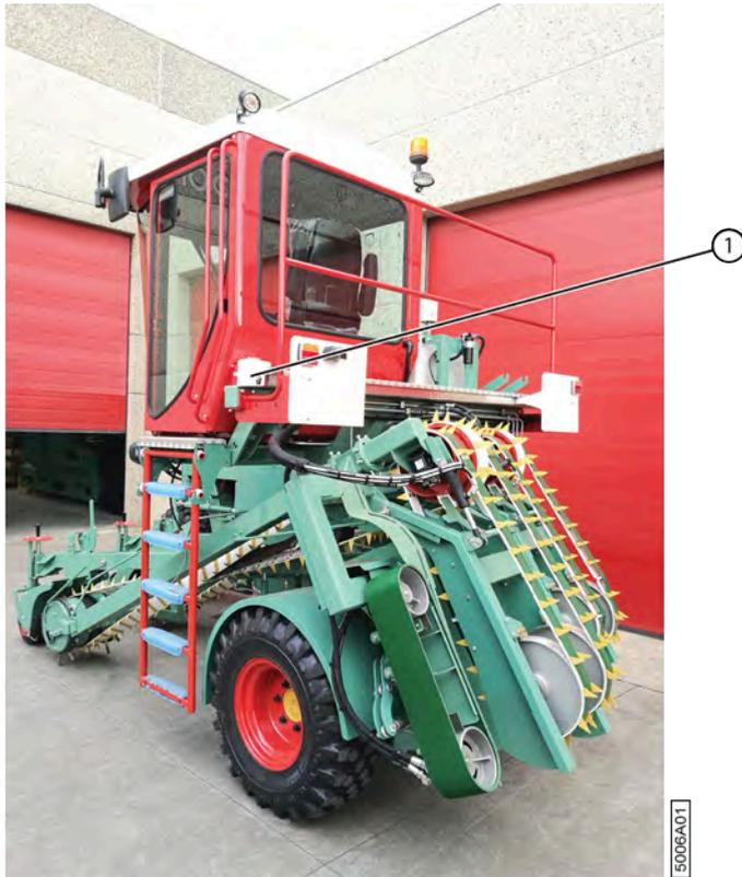
Fig. 15: Réservoir du liquide de lave-glace
