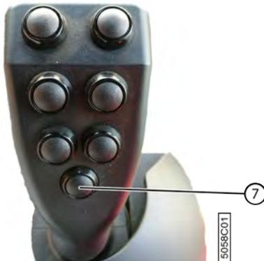
Fig. 77: Augmenter la vitesse des courroies avec le joystick
