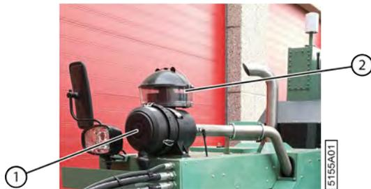
Fig. 32: Filtre à air et avant filtre
