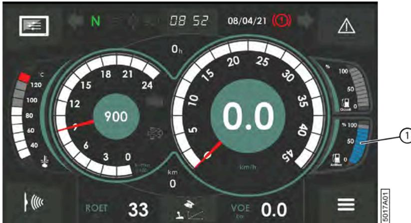
Fig. 56: Affichage du niveau AdBlue sur la fenêtre du mode route
