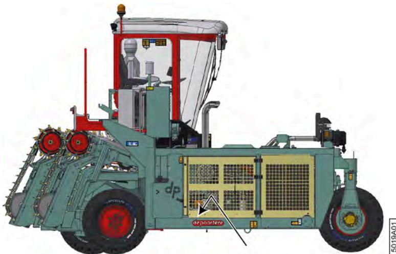
Fig. 3: Emplacement du numéro de châssis sur la machine
