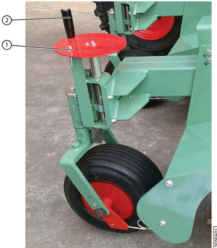
Fig. 86: Régler la hauteur du pick-up
