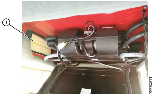
Fig. 135: Filtre à air dans la cabine
