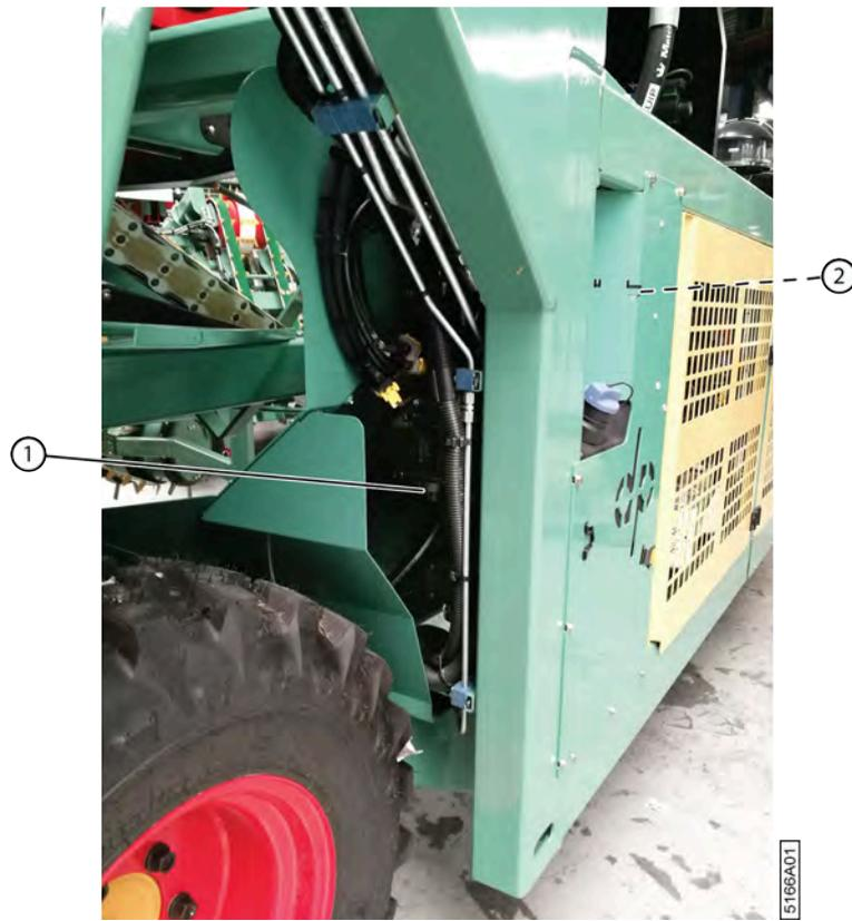
Fig. 139: Position des filtres d'AdBlue
