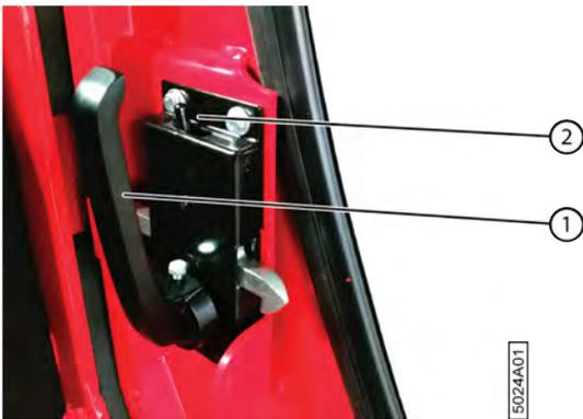
Fig. 10: Poignée de porte à l'intérieur de la cabine
