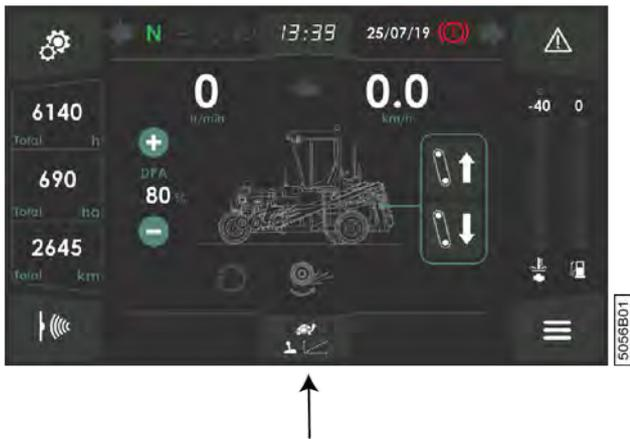
Fig. 72: Modifier le mode de conduite
