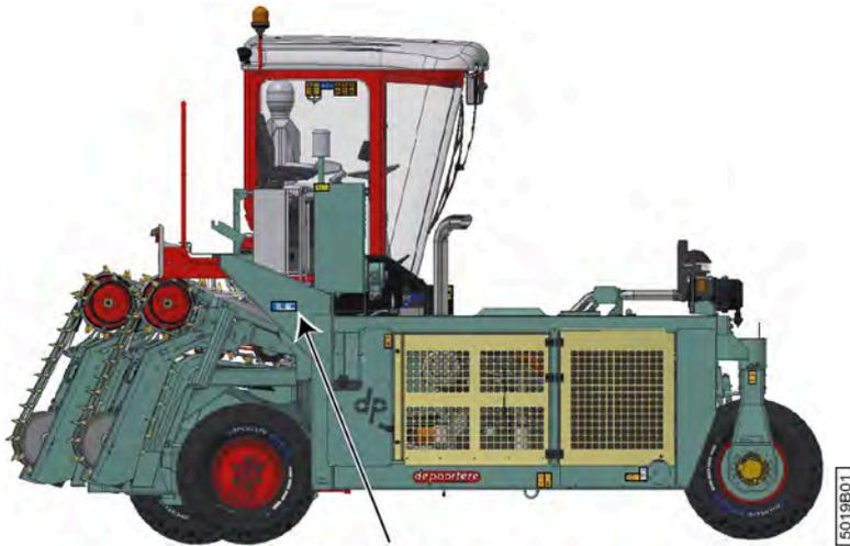
Fig. 1: Emplacement de la désignation du type de la machine
